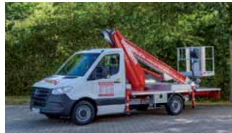
Im Gerken Mietprogramm: Die Arbeitsbühne GL 16 N mit einer Arbeitshöhe von 16 Metern kann vielseitig beim Baumschnitt einge- setzt werden.
