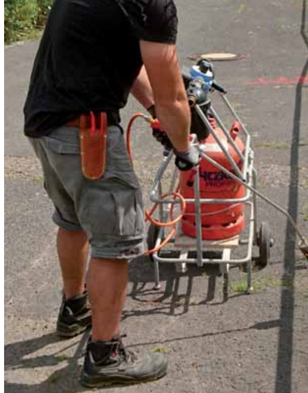
Das Abflammen ist auf allen befestigten Wegen einsetzbar.
