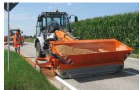
Die Optimas Material-Verteilschaufel „Finliner“ mit 1,6 m³ Inhalt und größerer Ladeöffnung.
