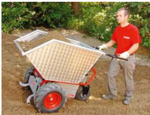
Der Akku-Transporter TeMax transportiert Lasten bis 350 kg.
