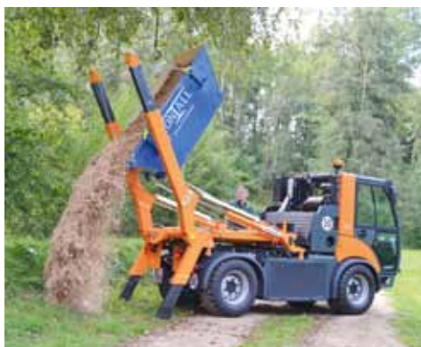
Ein Alleskönner: Der neue Multicar M29 schafft Nutzlasten von bis zu 3,2 Tonnen.
